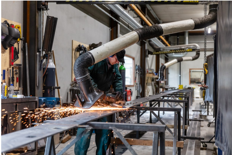
De randen van enkele boorgaten in een roedplaat worden met een slijptol weggeslepen.
