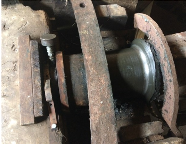
De pen van de as van 'de Blazekop' in Ovezande. Hier is de as wel doorboord, omdat de molen is uitgerust met een Bilau wieksysteem. Ook is een staufferpot voor de smering van het lager gemonteerd.
