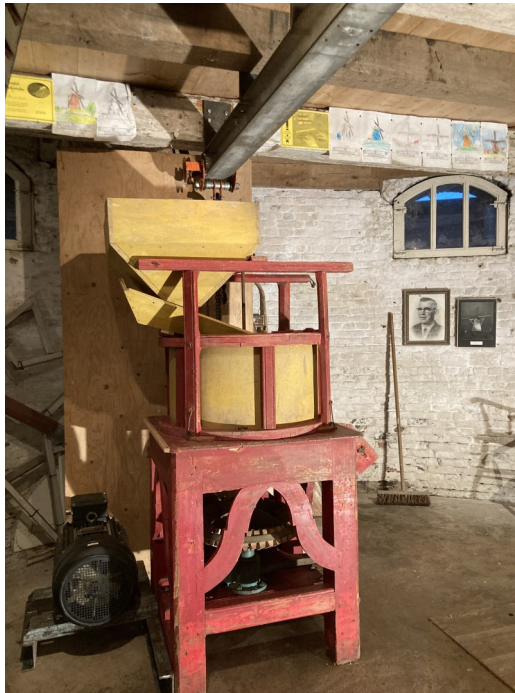
De gerestaureerde maalstoel wordt aangedreven door een forse elektromotor die ernaast staat opgesteld.
