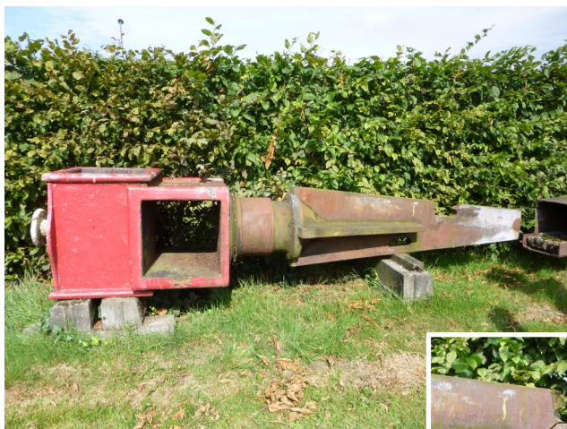
Gebroken insteekkop bij de molen in Moergestel. Hij heeft alle uiterlijke kenmerken van een 'Mercx Tilburg' insteekkop, toch draagt hij nergens deze naam. Op de inzetfoto is duidelijk te zien waar hij gebroken is. (foto's: Geert v. Stekelenburg)
