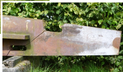
Gebroken insteekkop bij de molen in Moergestel. Hij heeft alle uiterlijke kenmerken van een 'Mercx Tilburg' insteekkop, toch draagt hij nergens deze naam. Op de inzetfoto is duidelijk te zien waar hij gebroken is. (foto's: Geert v. Stekelenburg)
