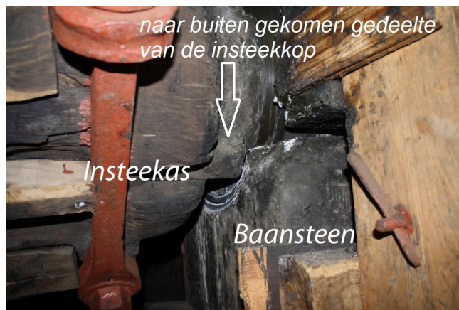
De vleugels van de insteekkop steken buiten de houten as. Aanvankelijk was dat een cm of 8, maar al snel werd dat meer. Je ziet ook dat de naar buiten stekende vleugels stukken uit de baansteen schrapen. (foto: Geert v. Stekelenburg)
